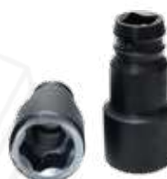
Klucz nasadowy, maszynowy do śrub łubkowych RZ 2/6 S-41 L-130
